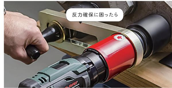
スライド軸を隣接するボルトに設置して反力確保
