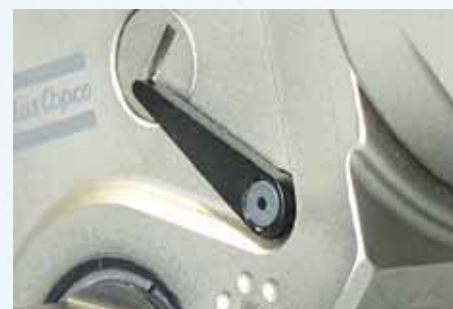
レンチをセットすれば、以降は手で押さえる必要がなく、ポンプ操作のみで作業が可能です。
