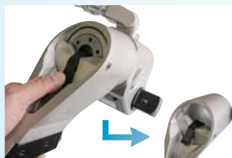
反力アームの脱着がワンタッチ。精密なスプライン式で5°刻みの角度調整が可能です。
