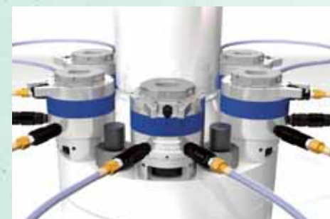
高圧油圧でボルトをスプリングのようにひっぱり上げ、その間にナットを回し締付を行う工具です。
