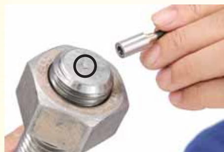
接着式トランスデューサを使えば常に同じポイントで測定ができるので経時変化の確認に最適です。
