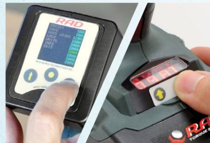
トルク設定はボタン式デジタル表示の「B-RAD」と、液晶パネル式の「DB-RAD」から選べます。
