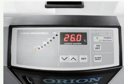
インバータチラー式冷却水循環装置採用で、水温が常に設定温度で保たれます。
