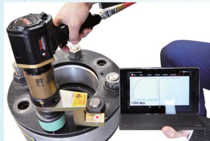
測定したデータはBluetoothでモバイル・PCにリアルタイムに転送され、その場で結果を確認できます。
