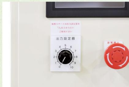
コイルやボルトが変わっても、加熱ボリュームを調整するだけで簡単に作業ができます。
