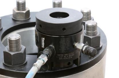
高圧油圧でボルトをスプリングのようにひっぱり上げ、その間にナットを回し締付ける工具です。
